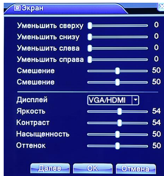
Рис. 3.19 Настройка выходного сигнала
